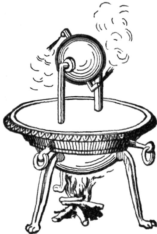
Abbildung 1.1: Abbildung eines Heronsballs. Unten befindet sich ein abgedichteter Wasserkessel, aus welchem durch eins der abgebildeten Rohre Wasserdampf in den Ball mit den zwei Düsen entweicht. Durch den Rückstoß beginnt sich der Ball zu drehen. Der sich drehende Ball wurde als Kuriosum gezeigt und hatte keinen praktischen Nutzwert. Quelle: Wikipedia.
